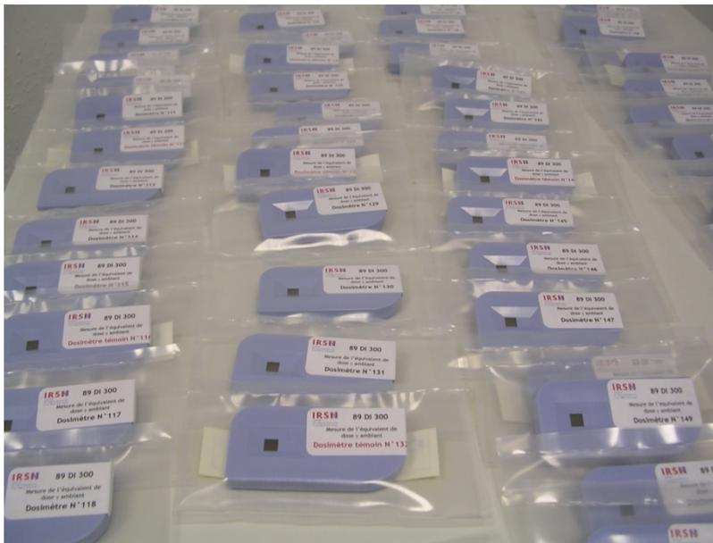
➔ La principale difficulté réside sur l'excès de temps d'exposition pour les dosimètres RPL de l'IRSN (stockage sur site, transport AR) vis-à-vis des sondes sur site
